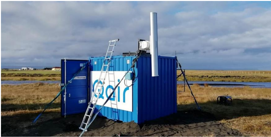
MYND 5.9 Uppsetning ratsjár fyrir lóðréttu stillingu.
